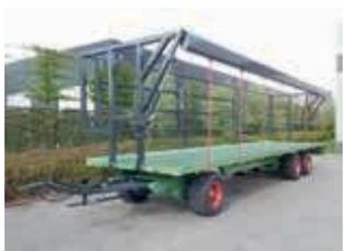
Construction solide en acier tubulaire Avec profil latéral pourvu avec système de callage hydraulique. Avec singles pour tenir la charge
