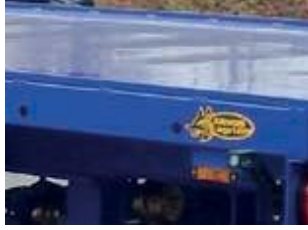
Afwerkrand type B Aanslagrand voor transport van groentencontainers. Met gaten in de zijkant voor bevestiging spanriemen. (elke 500 mm).
