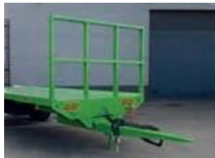
OPTIE OP-02 Recht kopschot hoogte naar keuze vast of demonteerbaar HOOGTEOPTEGEVENBIJUW BESTELLING
