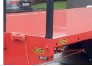
Afwerkrand type C Afwerking volledig plat.
