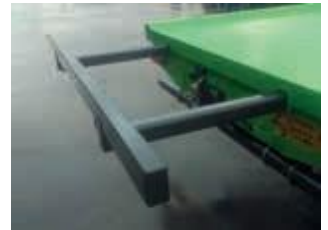
OPTIE OP-05 Uittrekbaar verlengstuk voor stro- of grasbalen. Max. 1 m lengte. Blokkeerbaar in 4 posities.
